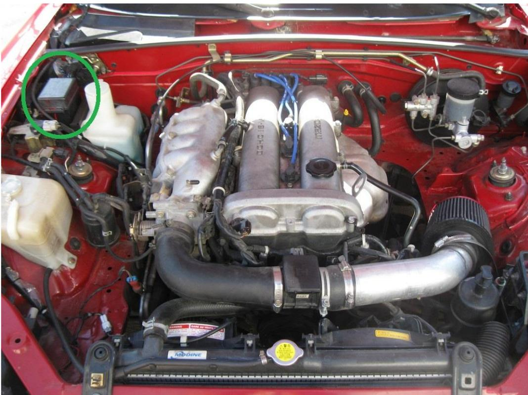
Le raccordement s'effectue en passant par le dessous (il est plus simple de désolidariser la boîte à fusible pour y accéder (2 écrous de 10))
